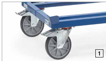
[1] Bodenschonend durch TPE-Bereifung
