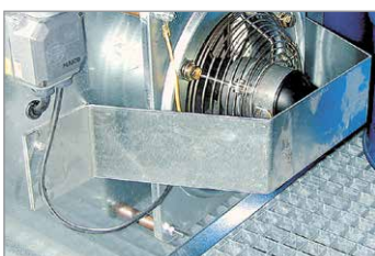
technische Zwangsventilation, ex-geschützt
