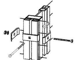
Pfosten-T-Anschluss mit T-Pfosten
