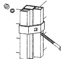
Pfosten-Eckanschluss mit Quadrat-Pfosten
