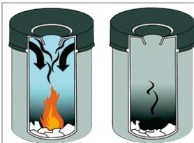
Wenn der Inhalt Feuer fängt, werden die aufsteigenden Verbrennungsgase durch den Löschkopf zurückgedrängt und stauen sich an der Einwurfföffnung. Die Sauerstoffzufuhr wird unterbrochen, das Feuer erstickt.
