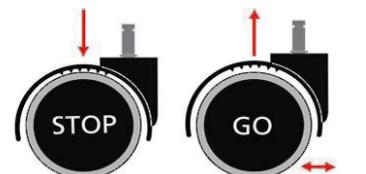
Hochstühle über 650 mm Sitzhöhe dürfen aus Sicherheitsgründen während der Nutzung nicht fahrbar sein. Mit den neuartigen Sitz-Stop-Rollen erfüllen Sie diese Forderung. Bei Entlastung wird jedoch der Stuhl automatisch mobil und rollbar.
